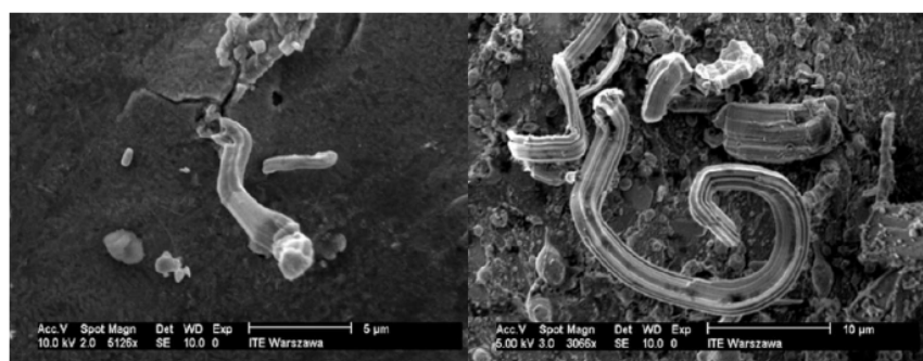
Rys. 34. Powierzchnia próbek: A - Sn100, B - Sn99,3Cu0,7Ni lutowanych bezpośrednio na pole kontaktowe Cu narażonych na działanie podwyższonej wilgotności (87% RH) i temperatury (+60°C) przez 3000 h [47 (4B-12)].
