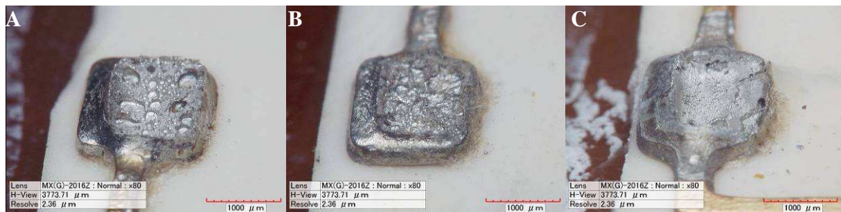
Rys. 11. Połączenia lutowane SAC305 po testach wytrzymałościowych: A – konwekcyjne lutowanie rozplywowe, B - lutowanie w parach nasyconych, C – lutowanie w parach nasyconych z opcją podciśnienia [16 (4B-4)].
